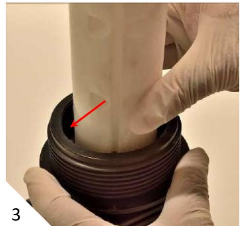
Introducir el flotador hasta la mitad del camino en el cuerpo [1], e introducir la varilla en la ranura de la goma desplegable de cierre hermético en el cuerpo, comprobando que se ha hecho en la dirección correcta [2]. Empujar el flotador y la varilla juntos hacia abajo hasta que estén trabados dentro del cuerpo [3].
