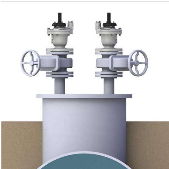
Dos interruptoras de vacío sobre una trampa de aire con llaves de cierre separadas. Las salidas se dirigen hacia fuera y las llaves de cierre a 45° de las salidas de las ventosas
