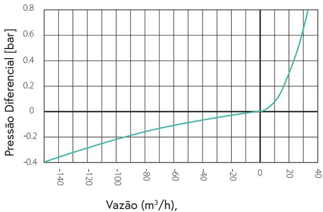
Vazão de descarga de ar
